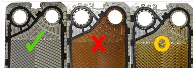
**Abbildung 4:** Gegenüberstellung einer unbenutzten, verschmutzten und gereinigten Wärmeübertragerplatte.
