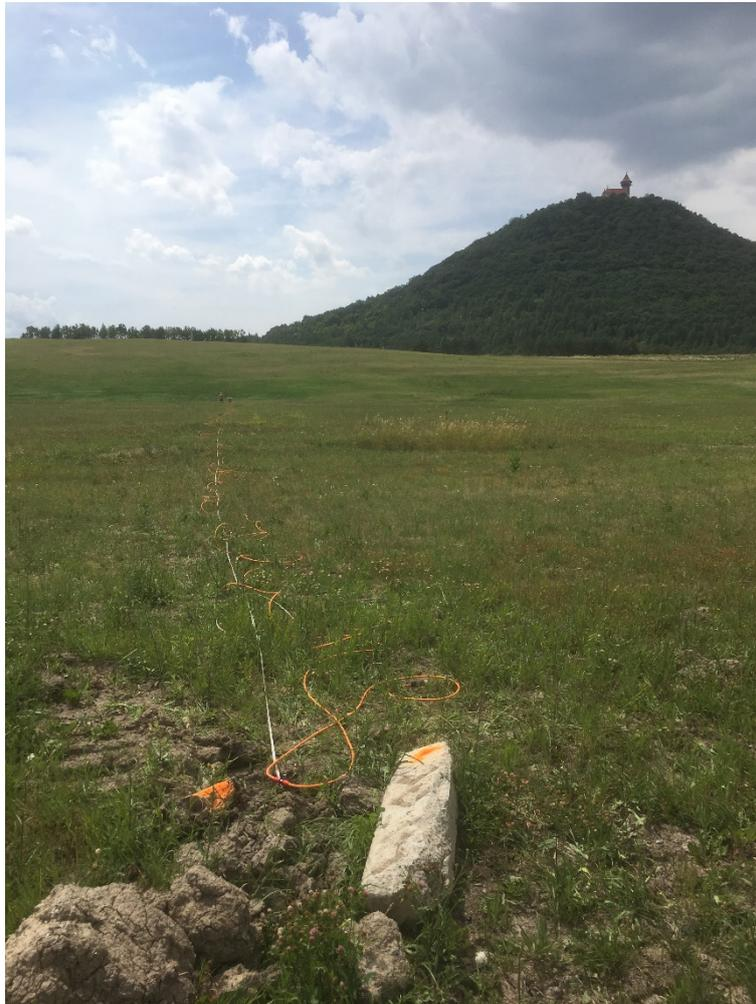
**Abbildung 7:** Anordnung der Elektroden ERT auf Profil P2 am Südufer des Sees (im Hintergrund Burg Hněvín).
