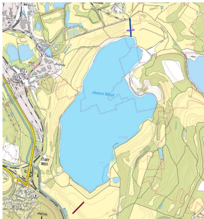
**Abbildung 8:** Lage der ERT Profile im Arbeitsgebiet (blau = Profile P1 und P3; rot = Profil P2).
