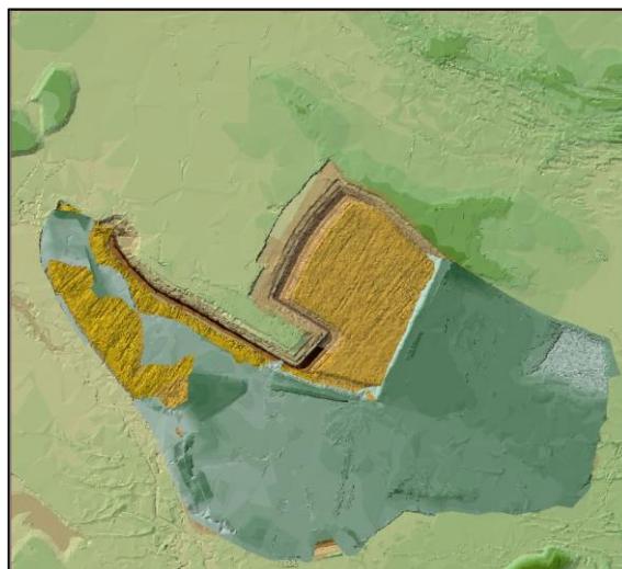
Obr. 2 Geometrický model Nochten - skryvkový most a zakladačová výsypka, stav: prosinec 2018
