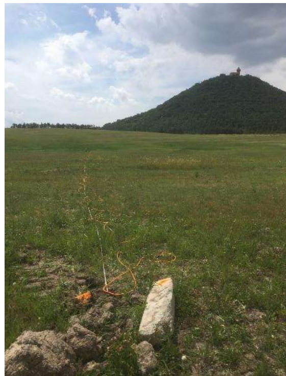
Umístění elektrod ERT na profilu na jižním břehu jezera Most (v pozadí Hněvín).
